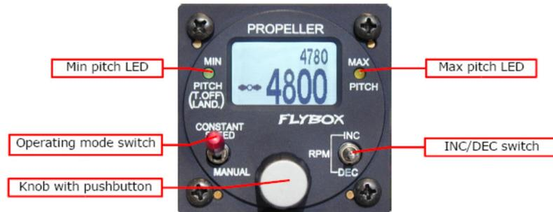
**Fig. 7.9-2 Boîtier régulateur hélice**
